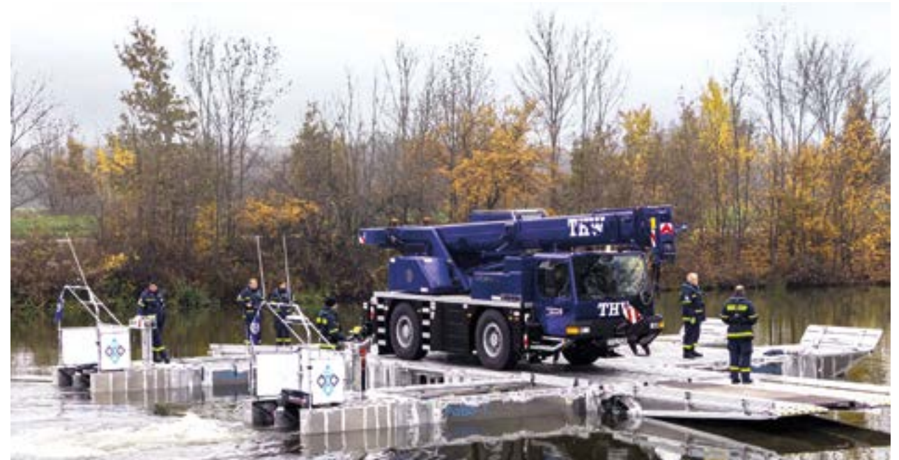
Ein PoBo-/HYDRA-Satz lässt sich unter anderem zu einer Transportplattform für hohe Nutzlasten kuppeln.
