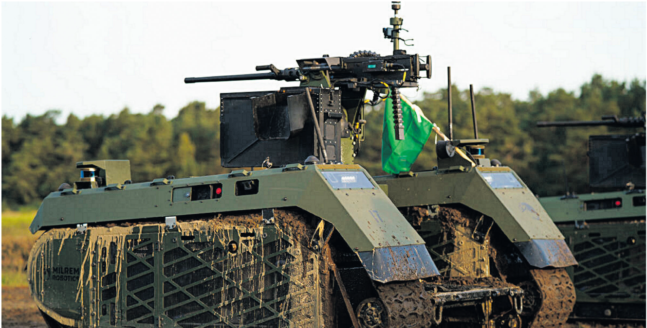
Unbemanntes bodengebundenes Fahrzeug TheMIS (Tracked Hybrid Modular Infantry System)
