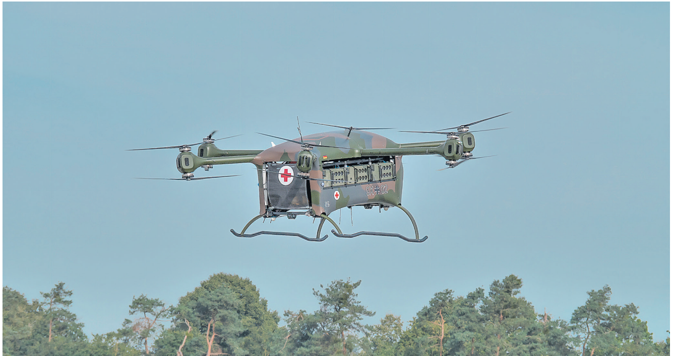
Die Rettungsdrohne Grille © ist ein unbemanntes Flugsystem für den Verwundetentransport zu Behandlungseinrichtungen
