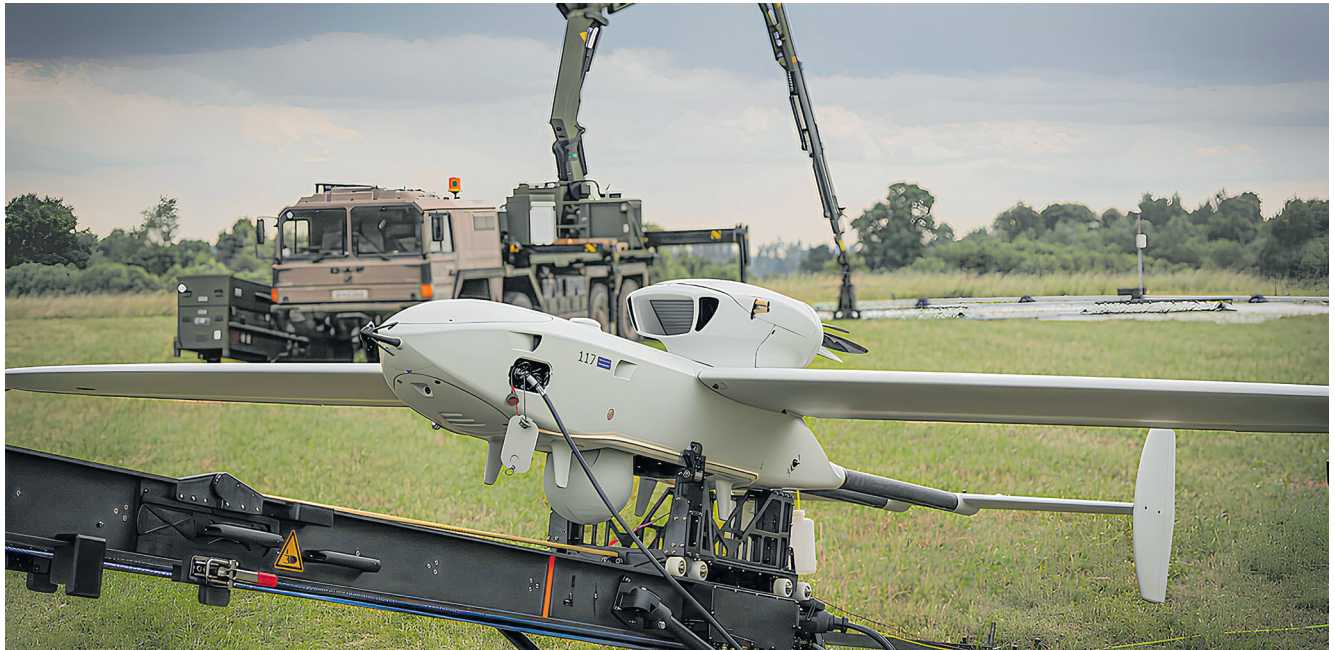
Das „Hocheffizientes Unbemanntes System zur Aufklärung mittlerer Reichweite (HUSAR)“ wird in der Heeresaufklärungs- und Artillerietruppe für die Lage-, Ziel- und Wirkungsaufklärung sowie Zielortung eingeführt.
