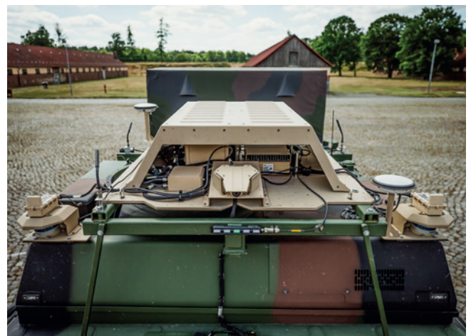
Ein Autonomy-Kit ist auf dem Dach des Militärfahrzeugs befestigt während des ersten Feldversuchs der elektronischen Deichsel im Rahmen des Planungsamt-Projekts „Unbemanntes Fahren von Landsystemen in der Bundeswehr“ auf dem Testgelände im Camp Fallingbommel.
